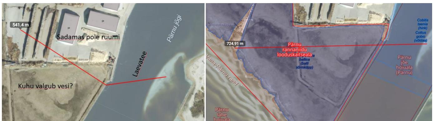
Joonis 6.1. Setete pumpamine Pärnu sadama territooriumile (vasak), setete pumpamine tulepaagi juurde rannale (parem).
