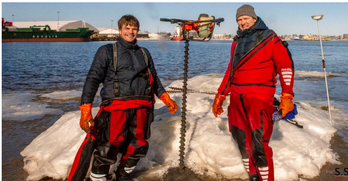
Foto 2.1. Puurimisel kasutati motoriseeritud käsi-tigupuuri.
